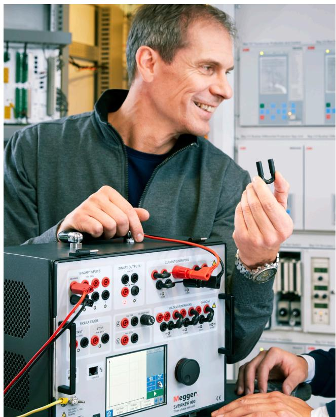
Finalmente, la entrada binaria del equipo de prueba de relés debe poder dispararse con la tensión de disparo producida por el relé.
