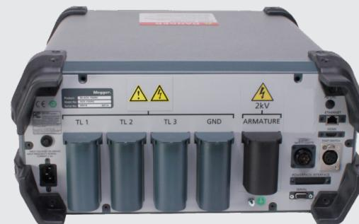
*Conexiones en el panel posterior para Ethernet, interfaz del Power Pack, HDMI, puerto serie, luces de advertencia remotas, parada de emergencia e interruptor de pedal*
